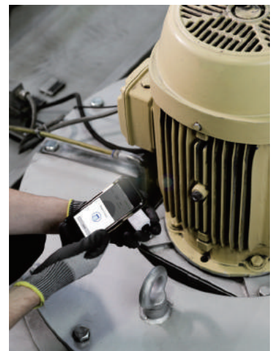
세플러 OPTIME 앱을 사용하여 센서를 활성화하고 통합합니다.
