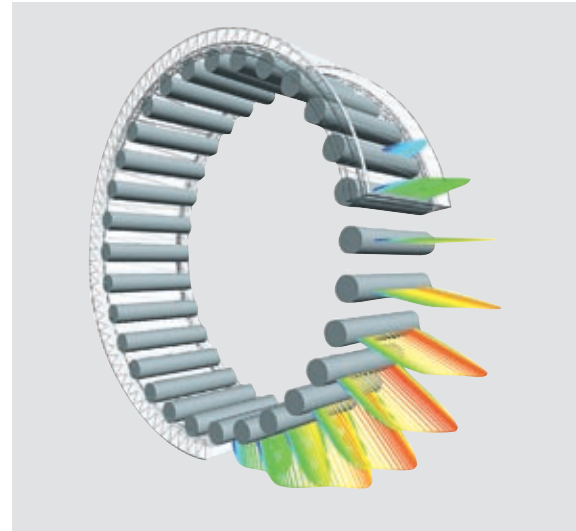
Accurate in every detail: 각각의 전동체의 실제 접촉 응력 값에 대한 해석이 가능합니다
