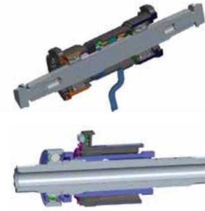
센서 바텀 브래킷(Sensor Bottom Bracket) 단면모습
