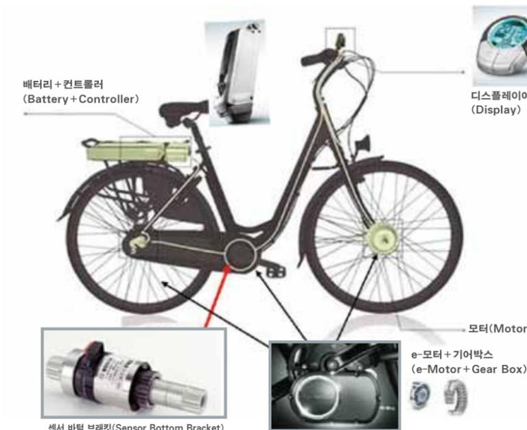
전기자전거에 설치된 센서 바텀 브래킷(Sensor Bottom Bracket) 및 주요부품
